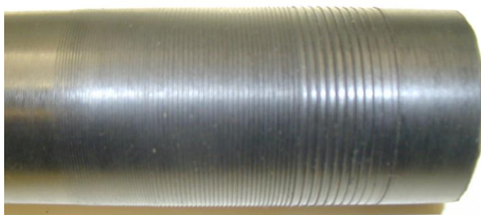
Рис. 5. Начальный участок полиэтиленовой трубы с зоной внедрения инструмента для ДР
