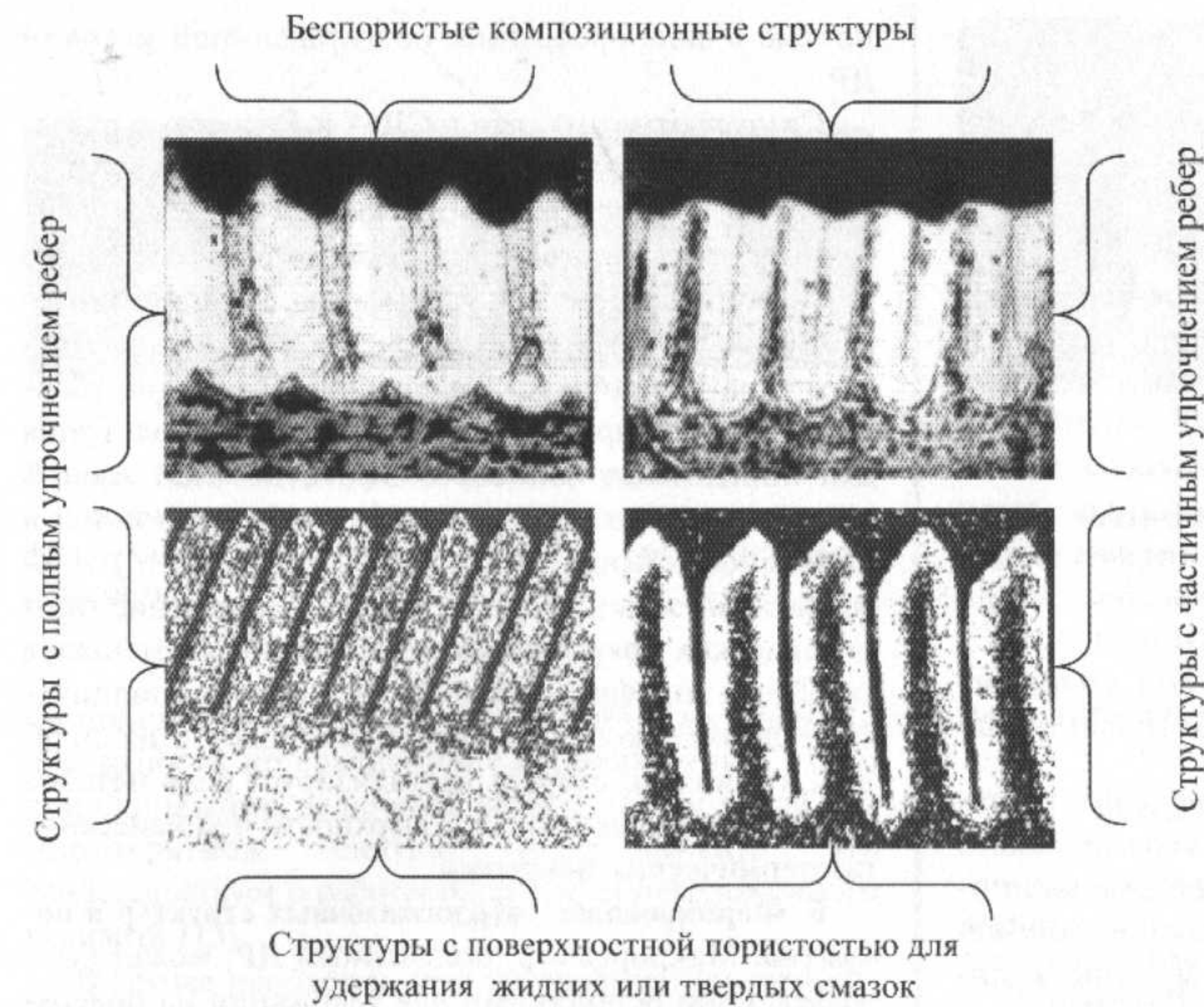
Рис. 9. Варианты модификации поверхностей стальных деталей на основе химико-термической обработки макро- и микрорельефов, полученных ДР
