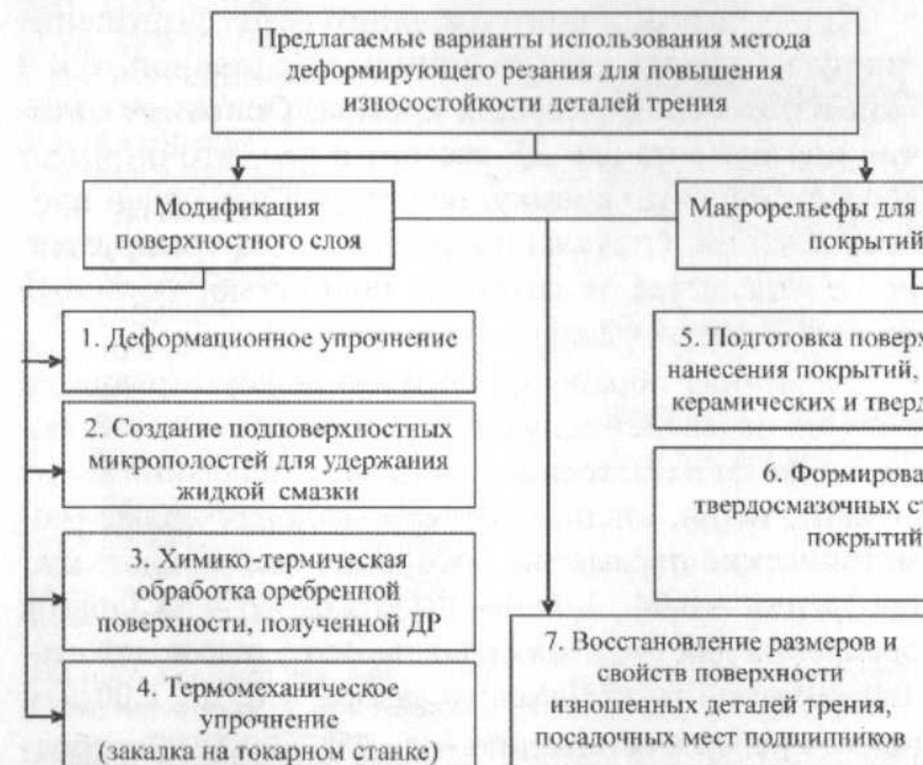
Рис. 2. Варианты использования метода ДР для повышения износостойкости деталей трения
